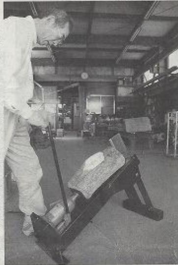
曾根鉄工房とLab72が共同開発した手動式のまき割り機
