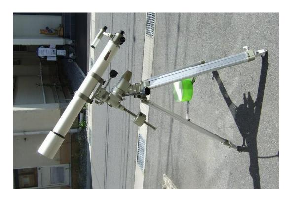
① ビクセン スーパーポラリス 102M 口径 100mm、焦点距離 1000mm、口径 100mm とかなり大きくなりました 重量約 21Kg
