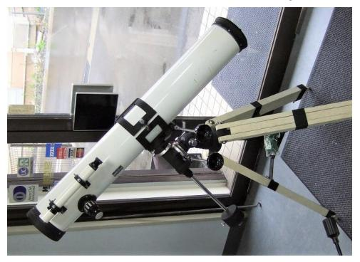
③ ビクセン ハレーR-1000 口径 100mm 焦点距離 1000mm 1 台 赤道儀はニューポラリス型 重量 約 20Kg
