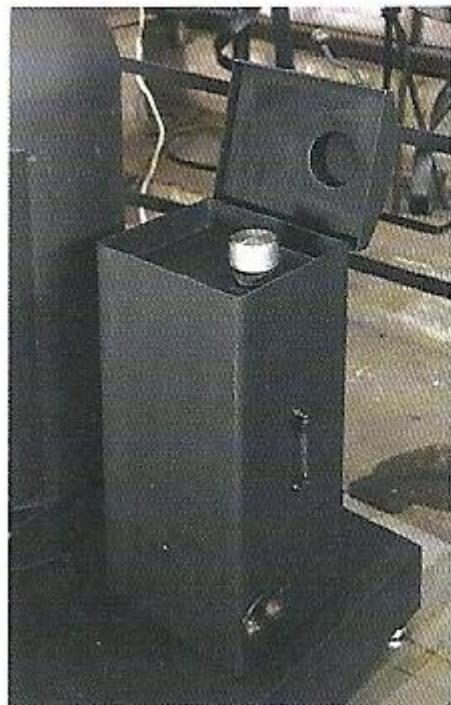
水はタンクから台座に入り、ボイラーへと自動給水される。燃焼室下部をドーナツ状に囲んだボイラーの中で水が沸騰し、水蒸気へと変わる。
