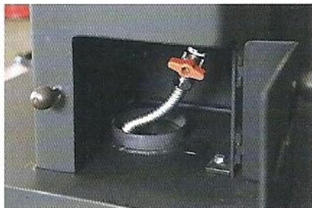
水量調整用のコックは、水を補給する時以外は開閉しない。一度開けておいたら、自動的にボイラーに給水される。
